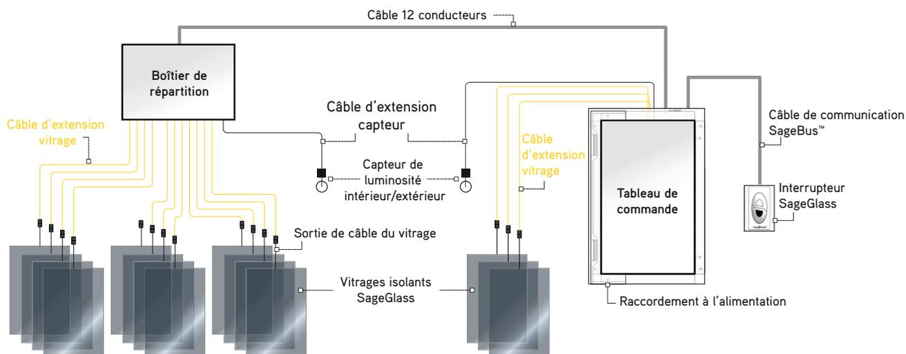
La sortie de câble du vitrage est connecté au câble d'extension vitrage, lui-même connecté au boîtier de répartition ou au tableau de commande.
