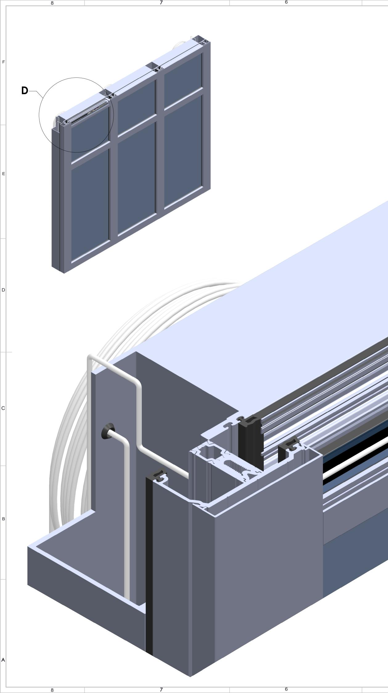
CONNECTOR ASSEMBLY INSIDE THE GLAZING POCKET OF HORIZONTAL MULLION
